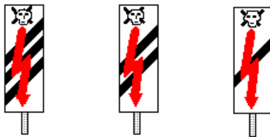
Fig. 209. Balize avertizoare pentru indicarea intrării pe secții de circulație cu linie electrificată.
