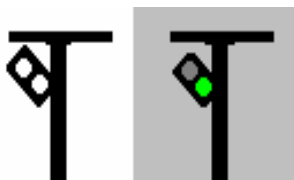
Fig. 10. LIBER cu viteza stabilită. Semaforul următor este pe liber pe linia directă.
