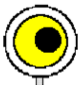
Fig. 141. Indicatorul permanent pentru acoperirea punctului de secționare de pe secțiile cu conducere centralizată a circulației trenurilor.
